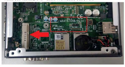
Step 5. 将 SSD 斜插入插槽至底后,向下压 SSD,并锁上固定螺丝。
