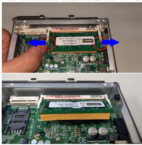
Step 5. 将内存斜插入插槽至底后,向下压内存,直到内存完全就位,确认插槽左右两侧卡扣夹在内存的边缘上。
