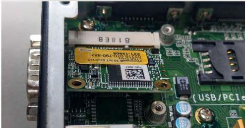
Step 4. mSata SSD 需安装在 CN5·板端标示为 mSata / USB / PCIe。
