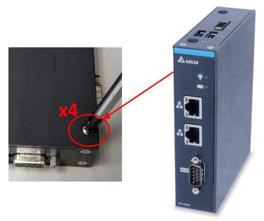
Step 3. 移除 mSata SSD 的固定螺丝,接着 mSata SSD 会往上弹起呈一斜角后,即可取出 SSD。
