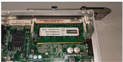
Step 4. "同时"将卡扣上的金属往外拉,接着内存会往上弹起呈一斜角后,即可取出内存。
